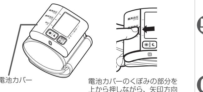
電池カバーのくぼみの部分を上から押しながら、矢印方向にすらします。
