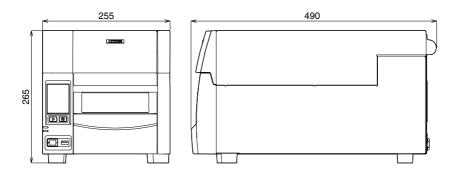
Approx. 255 (W)  $\times$  489 (D)  $\times$  385 (H) mm/ 10 (W)  $\times$  19.3 (D)  $\times$  15.2 (H) inch (CL-S700 III R)
