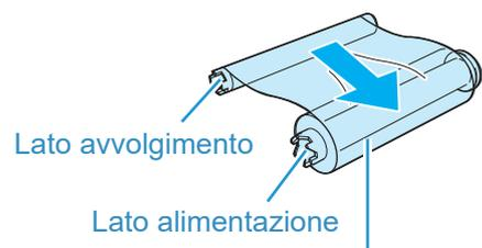
Ruotare in direzione della freccia per eliminare l'allentamento.
