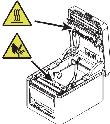
Ces étiquettes indiquent le risque de brûlures en cas de contact avec la tête qui devient chaude et le risque de coupures au niveau des mains en cas de contact avec le système de découpe automatique lors de l'ouverture du capot papier.
