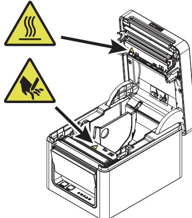
Estas etiquetas indican que el cabezal se calienta; de modo que si se toca, se pueden producir quemaduras, y si se toca la cizalla automática al abrir la tapa del papel, se pueden producir cortes en las manos.
