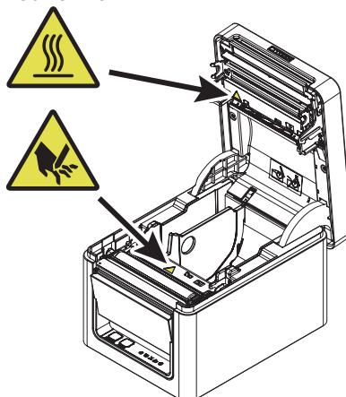
Diese Aufkleber weisen darauf hin, dass der Druckkopf heiß wird und beim Berühren Verbrennungen verursachen kann. Zudem besteht die Gefahr von Schnittverletzungen an den Händen, wenn der automatische Papierschneider beim Öffnen der Papierabdeckung berührt wird.
