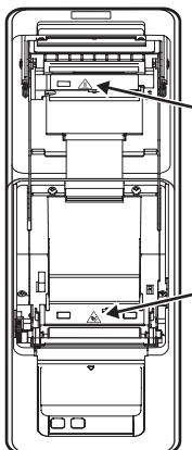
ESTA ETIQUETA INDICA EL RIESGO DE QUEMADURAS DEBIDO A LA ALTA TEMPERATURA DEL CABEZAL DE IMPRESIÓN Y EL RIESGO DE CORTARSE CON LAS CIZALLAS AUTOMÁTICAS MIENTRAS LA TAPA DEL PAPEL ESTÁ ABIERTA.
