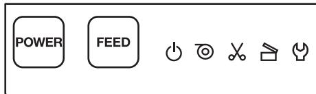
Das Bedienungsfeld verfügt über fünf LED-Anzeigen und zwei Tasten.
