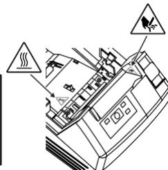
**CES ÉTIQUETTES INDIQUENT LE RISQUE DE TOUS DOMMAGES DUS À LA «TEMPÉRATURE ÉLEVÉE» DE LA TÊTE D'IMPRESSION ET DU «BORD DENTELÉ» DU MÉCANISME DE DÉCOUPE MANUELLE.**
