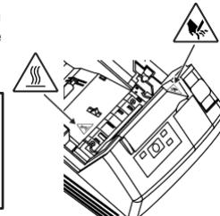
**ESTAS ETIQUETAS INDICAN EL RIESGO DE CUALQUIER LESIÓN DEBIDO A "ALTA TEMPERATURA" DE LA CABEZA DE IMPRESIÓN Y "BORDE DE DIENTE DE SIERRA" DE LA CORTADORA MANUAL.**
