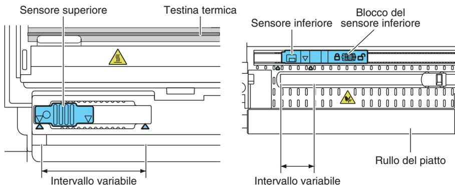
L'intervallo di regolazione orizzontale del sensore superiore e inferiore è di 10 incrementi dai simboli a triangolo (▲).
