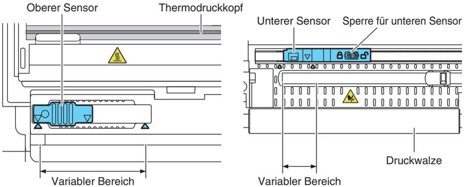
Der Bereich der horizontalen Anpassung des unteren und oberen Sensors liegt 10 Schritte zwischen der Dreiecksmarkierung (▲).
