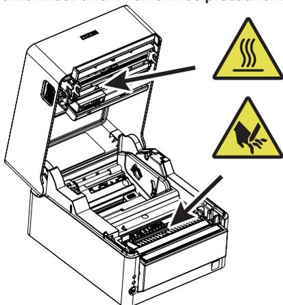
Ces étiquettes indiquent le risque de brûlures en cas de contact avec la tête qui devient chaude et le risque de coupures au niveau des mains en cas de contact avec le système de découpe automatique lors de l'ouverture du capot papier.
