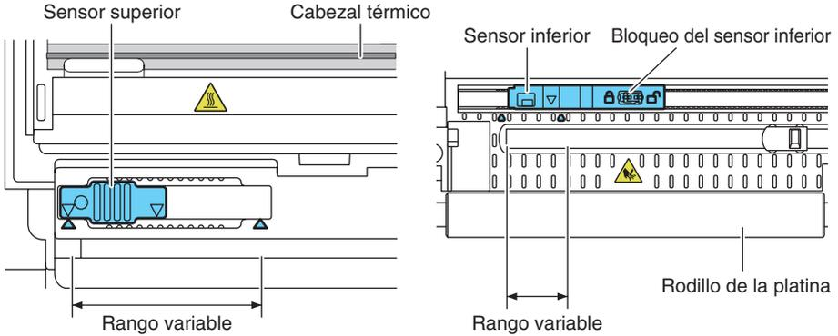
El rango de ajuste horizontal del sensor inferior y del sensor superior es de 10 pasos entre las marcas del triángulo (▲).
