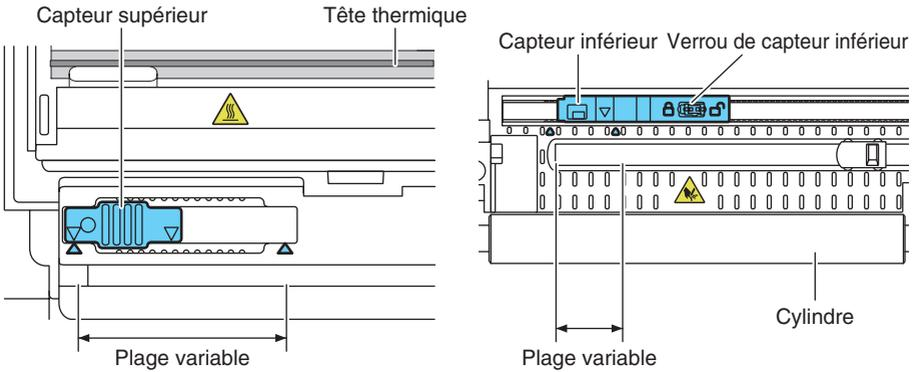
La plage de réglage horizontal du capteur inférieur et du capteur supérieur est de 10 crans entre les repères en forme de triangle (▲).
