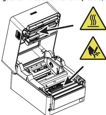
Estas etiquetas indican que el cabezal se calienta; de modo que si se toca, se pueden producir quemaduras, y si se toca la cizalla automática al abrir la tapa del papel, se pueden producir cortes en las manos.
