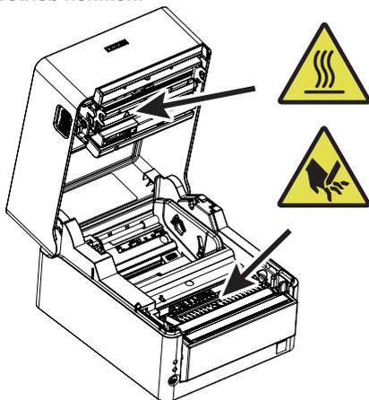
Diese Aufkleber weisen darauf hin, dass der Druckkopf heiß wird und beim Berühren Verbrennungen verursachen kann. Zudem besteht die Gefahr von Schnittverletzungen an den Händen, wenn der automatische Papierschneider beim Öffnen der Papierabdeckung berührt wird.
