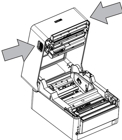
3. Legen Sie das Rollenpapier mit der bedruckbaren Seite nach außen wie durch den Pfeil A gezeigt und ohne Durchhang ein.
