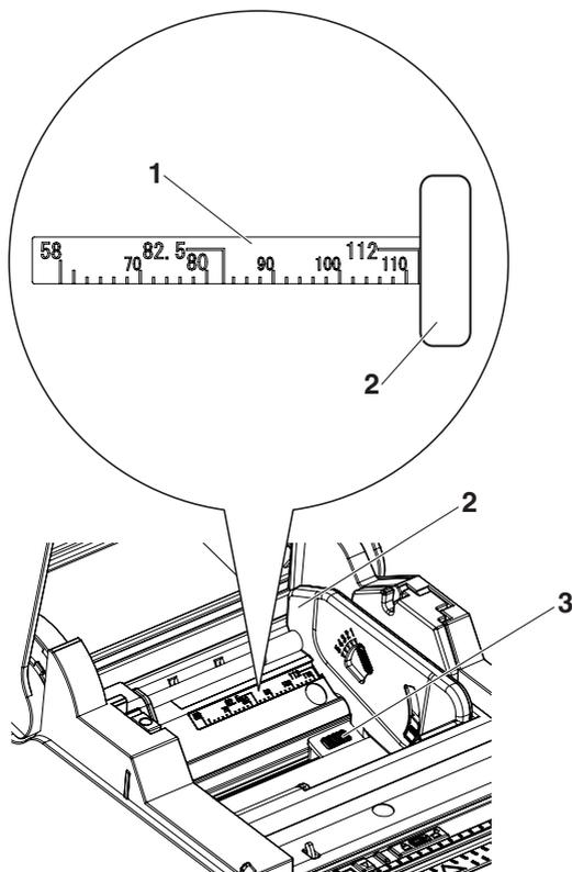
1. Échelle de mesure de la largeur du papier (unité : mm)
