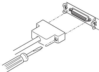
3. **Inserte el otro conector firmemente en el puerto de interfaz de del ordenador host.**
