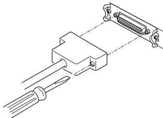
3. **Inserire l'altro connettore saldamente nella porta di interfaccia del computer host.**
