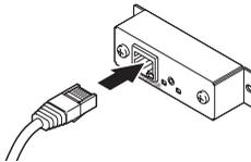
3. **Verbinden Sie den anderen Stecker mit einem Hub, Router oder einem ähnlichen Gerät.**
