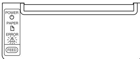
Se l'ERROR LED lampeggia, eliminare il blocco dispositivo di taglio come spiegato di seguito.
