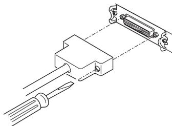
3. Insérez solidement l'autre connecteur dans le port de l'interface de l'ordinateur hôte.
