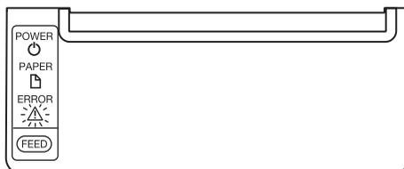
Si el piloto ERROR LED parpadea, desbloquee la cizalla como se indica a continuación.
