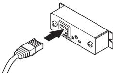
3. **Conecte el otro conector a un concentrador (hub), router o dispositivo similar.**
