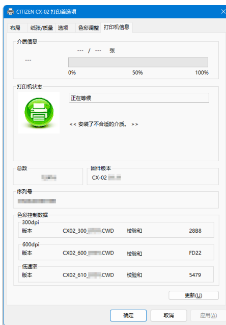
图 2.2.6.2 表示安装了不合适的介质
