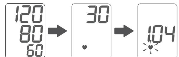
メモリー値(前回の測定結果)を約2秒間表示します。脈拍を感じると♥マークが点滅します。
