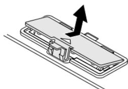
1 電池ケースのフタのフックをマーク(△)方向に押しながら、矢印の方向へはずします。
