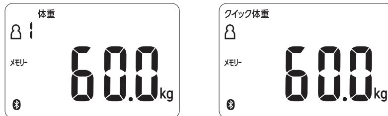
体組成計として使用している場合、測定結果が[体重→BMI→体脂肪率→内臓脂肪レベル→筋肉量→基礎代謝量→推定年齢→骨格筋率→皮下脂肪率→体水分率]の順に1度表示されます。各項目の表示途中、もしくは一巡したあとは体重の表示に戻ります。◀/▶ボタンをタッチすると、表示が切り替わります。
