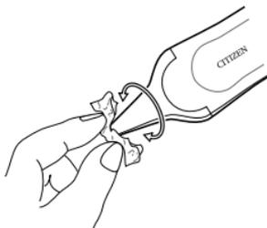
先端のプローブ部が汚れていると検温精度に影響を及ぼします。測定後にプローブ窓を確認し、必ずきれいな状態で保管してください。
