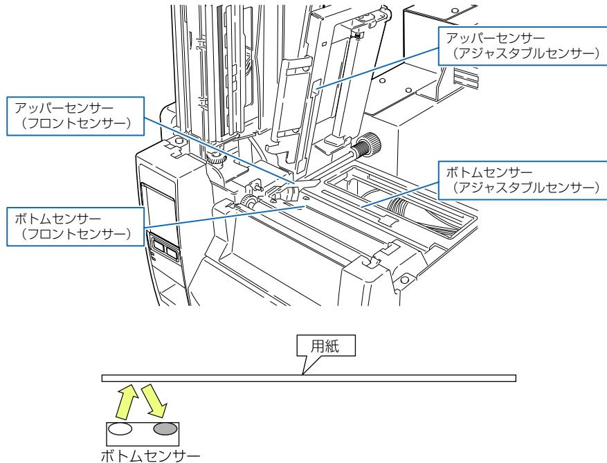
3. センサー調整を行います。メニュー画面の“テスト&マシン情報”->“テストモード”->“センサー調整”より“反射”を選択し画面下部の“OK”ボタンを押します。表示される画面の“開始”ボタンを押すとセンサーを自動調整します。
