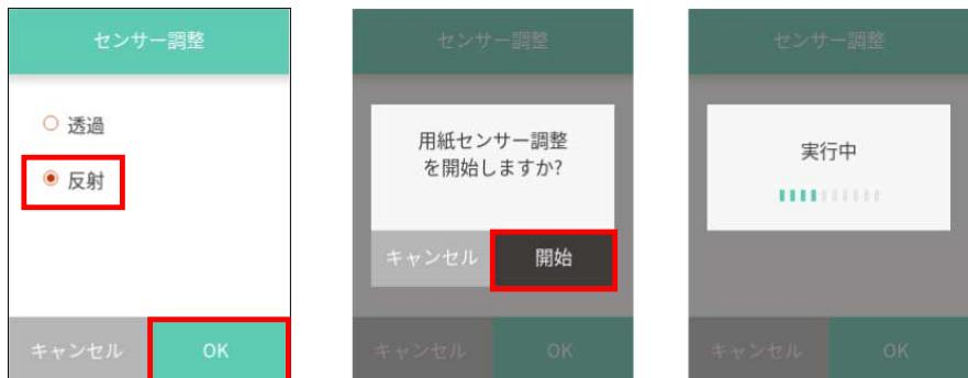
4. 自動調整が正常に終了するとディスプレイに“OK”と表示されます。異常終了（調整が不可能）するとエラーLEDが点滅し、ディスプレイに“失敗”と表示されます。
