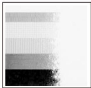
左のサンプルは、間違ってセットされた「ヘッド圧バランス（用紙幅）調整」を示しています。
