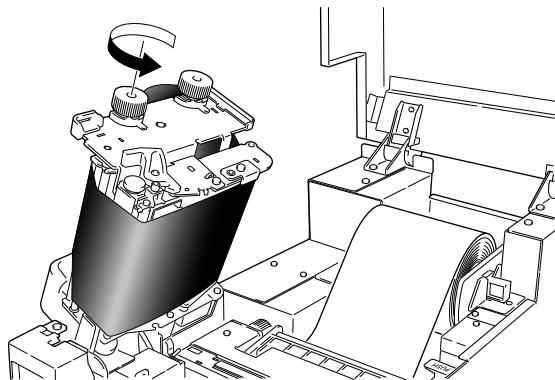
6. ヘッドクローズノブを押して、ヘッドユニットを「カチッ」と音がするまで押し込んでください。ヘッドユニットをロックする際は、必ずヘッドクローズノブを押してください。
