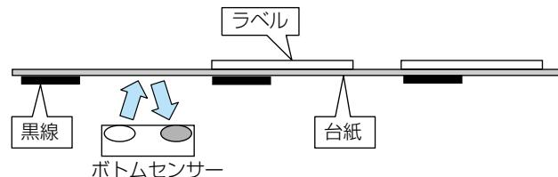
3. センサー調整を行います。メニュー画面の“テスト&マシン情報”->“テストモード”->“センサー調整”より“反射”を選択し画面下部の“OK”ボタンを押します。表示される画面の“開始”ボタンを押すとセンサーを自動調整します。
