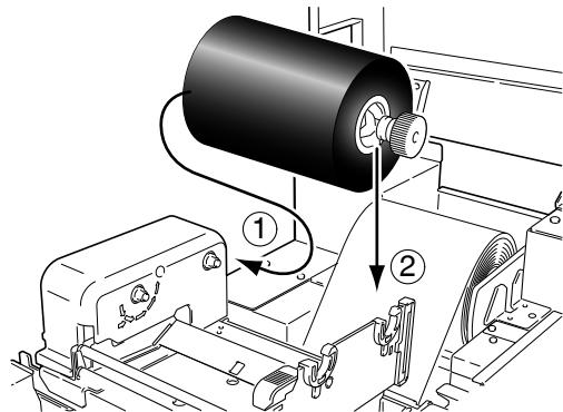
3. ヘッドオープンレバーを押し、ヘッドユニットを開けます。ヘッドユニット下部から、リボン巻き取り側ヘリボンを引き出します。
