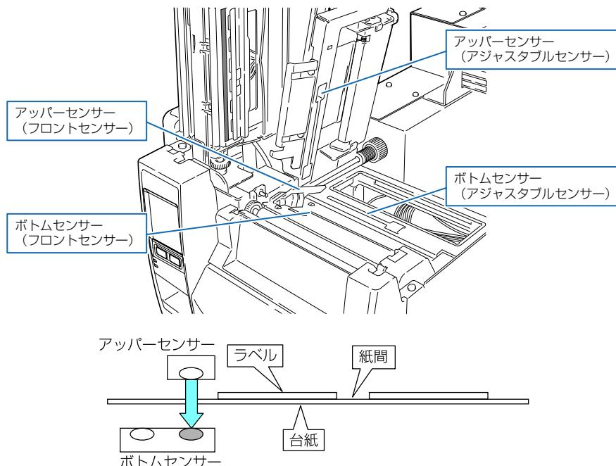
3. センサー調整を行います。メニュー画面の“テスト&マシン情報”->“テストモード”->“センサー調整”より“透過”を選択し画面下部の“OK”ボタンを押します。表示される画面の“開始”ボタンを押すとセンサーを自動調整します。
