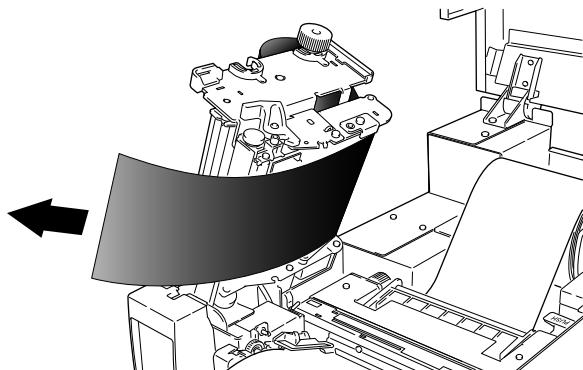
4. 引き出したリボンを紙管をセットしたリボンホルダーにテープ等で固定し、巻き付けます。
