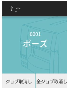
2. 表示された画面の“ジョブ取消し”ボタンを押すとジョブが削除されます。
