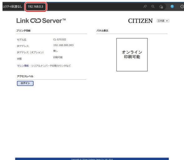
2. [LOG IN]ボタンを押して、認証画面を表示します。工場出荷状態では認証用パスワード設定画面が表示されます。
