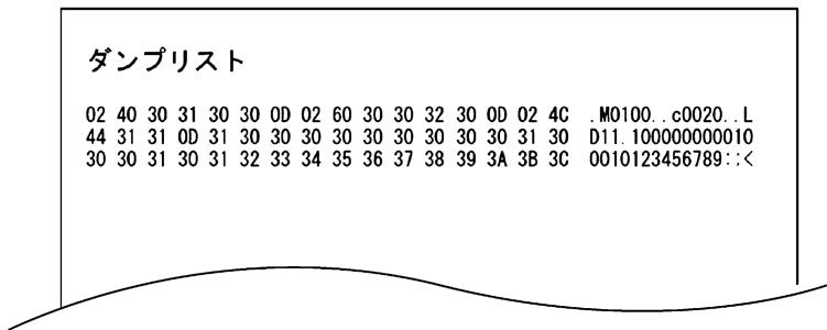
※ HEX ダンプモードから抜ける場合は、プリンター本体の電源を切り、再度電源を入れ直して（再起動して）ください。
