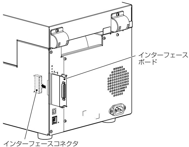
3. 取り外したネジ（2本）を使って、インターフェースボードをプリンターに固定します。
