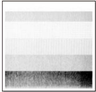
左のサンプルは、間違ってセットされた「ヘッドオフセット（用紙圧）調整」を示しています。
