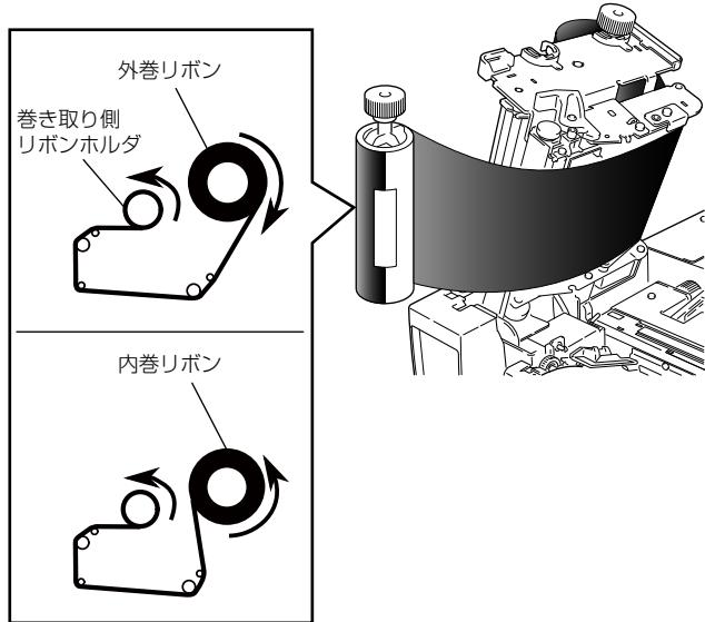
5. 紙管をセットしたリボンホルダーをリボン駆動ユニットにセットし、矢印方向に回してリボンのたるみ、しわを取り除きます。
