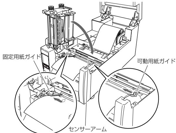
7. ヘッドクローズノブを押して、ヘッドユニットを「カチッ」と音がするまで押し込んでください。ヘッドユニットをロックする際は、必ずヘッドクローズノブを押してください。装着した用紙（ラベル）に合わせて、ヘッドオフセット（用紙厚）調整ネジおよびヘッド圧バランス（用紙幅）調整ノブで調整を行ってください。各調整方法は「4. プリンターの調整」を参照してください。
