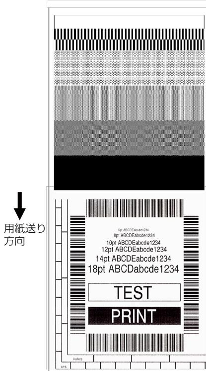
セルフテスト印刷を行い、下記のようなパターンが印刷された場合は、「ヘッド圧バランス（用紙幅）調整」および「ヘッドオフセット（用紙圧）調整」を行ってください。各調整方法は「4. プリンターの調整」を参照してください。
