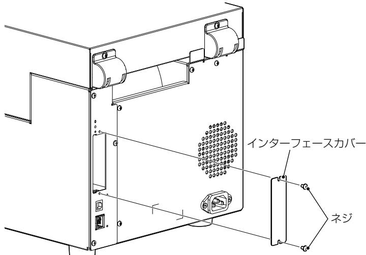
2. インターフェースボードをスロットに挿入して、プリンター内部にあるインターフェースコネクターに接続します。
