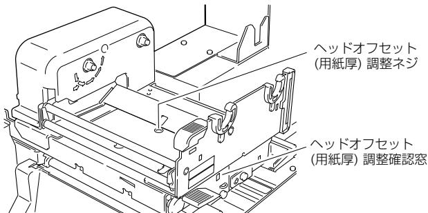
プリントヘッドの過熱部分とヘッドオフセット(用紙厚)調整確認窓の関係は下図の通りです。
