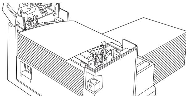
3. 設定キーを押しながらポーズキーを押して離すと、センサーを自動調整します。
