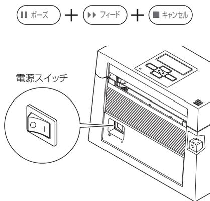
2. “センサー調整”と表示されたらキーを離してください。センサー調整モードに入ります。
