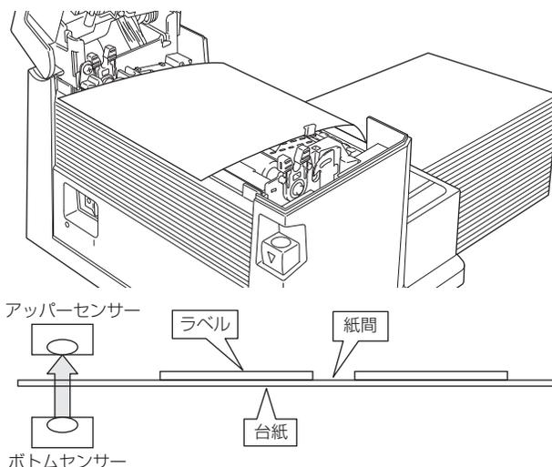
3. 設定キーを押しながらポーズキーを押して離すと、センサーを自動調整します。
