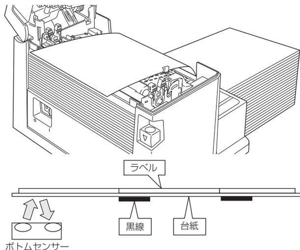
3. 設定キーを押しながらポーズキーを押して離すと、センサーを自動調整します。
