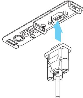
3. 接続コネクターのもう一方を、ホストコンピューターのインターフェースコネクターへしっかりと差し込みます。
