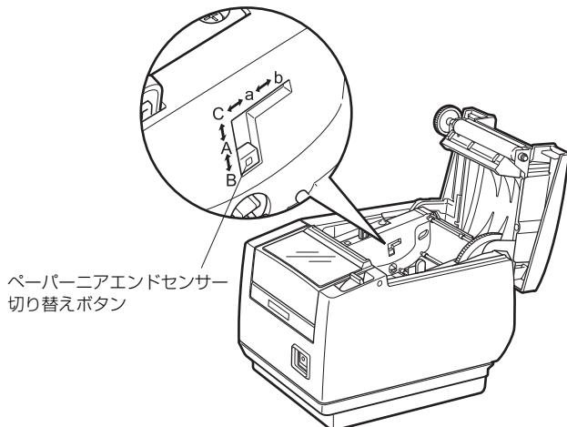
(A / B 方向は横置き、a / b 方向は縦置きまたは壁掛け時の位置を示します。)
