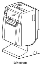
縦置き、壁掛けの場合は、ペーパーニアエンドセンサーの設定を変更してください。(工場出荷時のペーパーニアエンドセンサーは横置き時の位置に設定してあります。)
