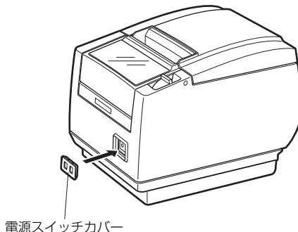
電源スイッチカバーを取り外す場合は、マイナスドライバー等の先端をカバーの溝に入れてひねります。
