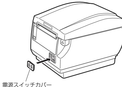
電源スイッチカバーを取り外す場合は、マイナスドライバー等の先端をカバーの溝に入れてひねります。
