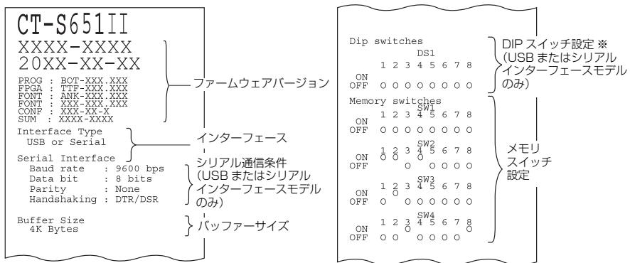
注) ※ :USBインターフェースモデルにDIPスイッチはありませんが、テスト印字ではDIPスイッチ設定がすべてOFFの状態で印字されます。
