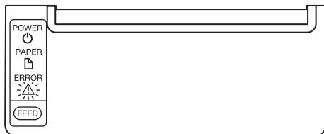
ERROR LEDが点滅した場合、以下の方法でカッターエラーを解除します。
