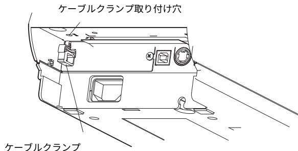
3. インターフェースケーブルの上下を確認してコネクターに接続します。
