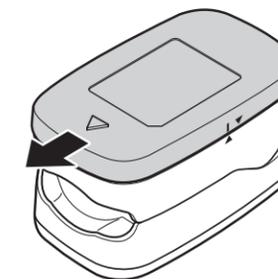
2. Asegúrese de introducir primero las pilas en el lado negativo ⊖ con los resortes salientes para no mezclar los terminales positivo ⊕ y negativo ⊖.
